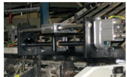
Rüstzeitverkürzung durch automatische Einstellung auf neue Formate
