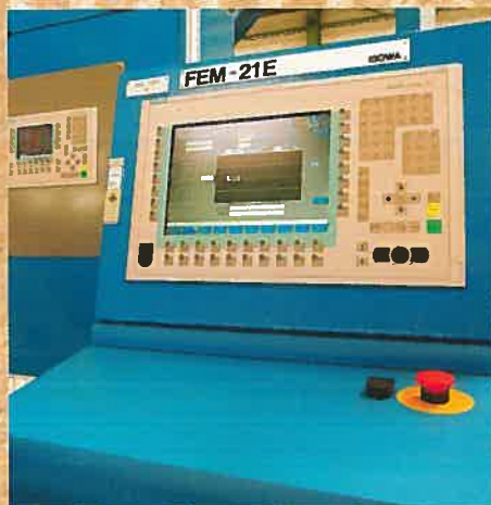
Herzstück des Bedien- und Beobachtungs-Systems ist ein leistungsstarker Simatic Panel PC 670
