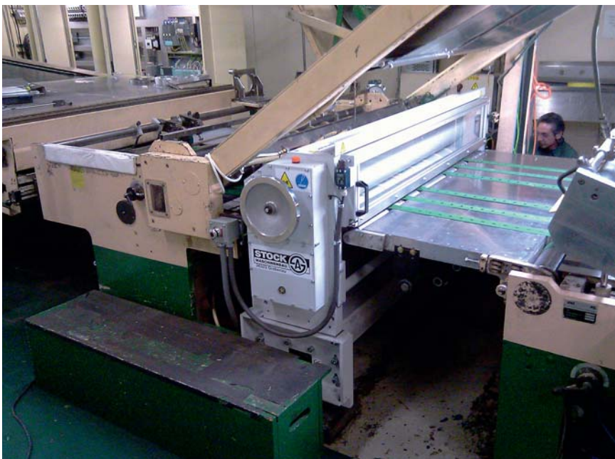
Als Option wurde im Zuge der Modernisierung einer Kaschiermaschine von Asitrade u. a. ein neuer Querschneider eingebaut (Hersteller: Stock), der den Leistungsumfang der Anlage erweitert.
