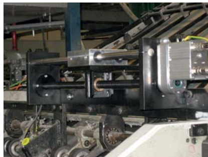
Rüstzeitverkürzung durch automatische Einstellung auf neue Formate
